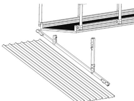
Fissaggio in caso di passerella perpendicolare all'onda.
