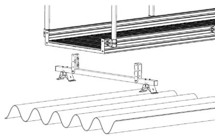
Fissaggio in caso di passerella nella stessa direzione dell'onda.
