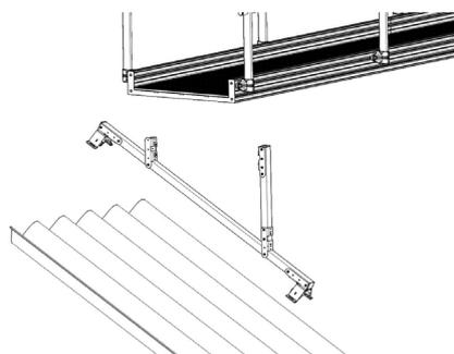
Fissaggio in caso di passerella perpendicolare all'onda.
