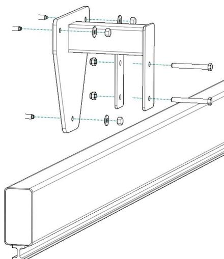
Per mantenere il binario in orizzontale, a volte è necessario disallinarlo rispetto ai fermi fermi del tetto. A tal fine, utilizziamo delle "candele" dimensionalmente adatte al disallineamento richiesto.
