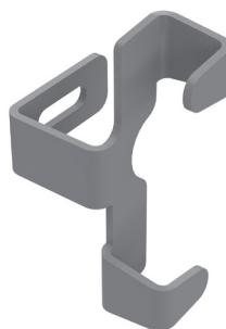
REF : 101187 Intermédiaire inox pour support béton. Fixation : 1 M12 A installer tous les 8 mètres.
