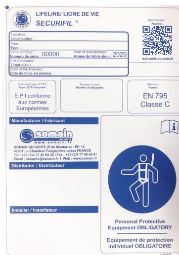
RIF: 100886 Cartello segnaletico: obbligo di indossare DPI, da posizionare a ogni accesso della linea vita. Disponibile nella lingua desiderata con possibilità di inserimento di un logo personalizzato.
