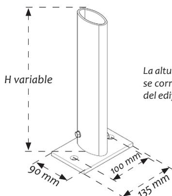
La altura del basamento se realiza a medida en nuestros talleres para que se corresponda con el grosor del complejo de estanqueidad/ aislamiento del edificio.
