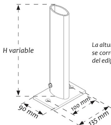
La altura del basamento se realiza a medida en nuestros talleres para que se corresponda con el grosor del complejo de estanqueidad/ aislamiento del edificio.
