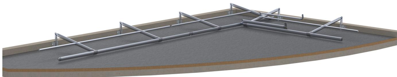
Rabattre les volées de garde-corps vers l'intérieur du dispositif. Faites l'opération inverse pour mettre le **SECURILISSE®** en position opérationnelle.
