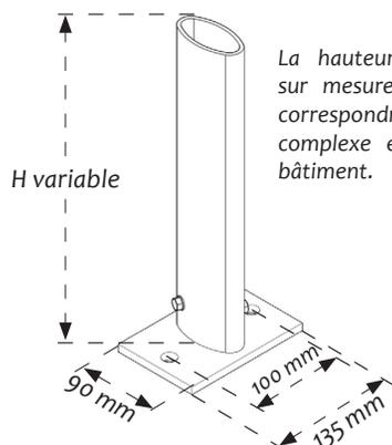
La hauteur de l'embase est faite sur mesure dans nos ateliers pour correspondre à l'épaisseur du complexe étanchéité / isolation du bâtiment.
