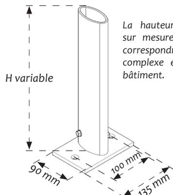
La hauteur de l'embase est faite sur mesure dans nos ateliers pour correspondre à l'épaisseur du complexe étanchéité / isolation du bâtiment.
