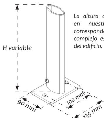
La altura del basamento se realiza en nuestras instalaciones para corresponder con el grosor del complejo estanqueidad / aislamiento del edificio.
