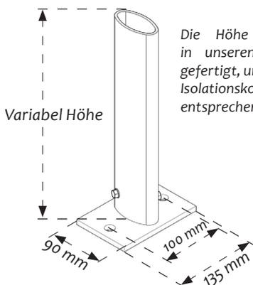
Die Höhe der Grundplatte wird in unseren Werkstätten auf Maß gefertigt, um der Dicke des Dichtungs-/Isolationskomplexes des Gebäudes zu entsprechen..
