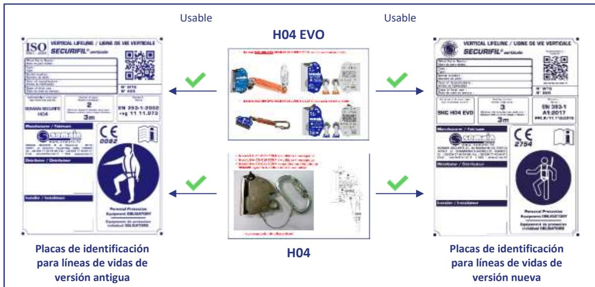
Para especificar las versiones del corredor compatibles con las líneas de seguridad y evitar confusiones en el sitio: hemos desarrollado una placa de identificación adicional que se instalará debajo de la placa de identificación obligatoria actual (según el diagrama a continuación).
