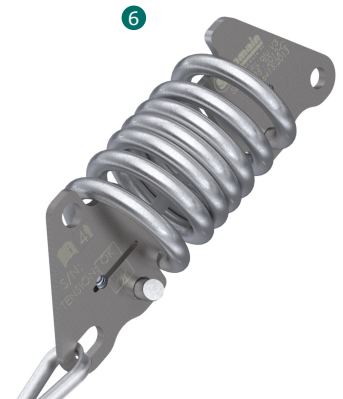
REF : 102173 Amortisseur d'énergie inox à oeil, installé à une extrémité de la ligne de vie, il permet de réduire les efforts sur la structure en cas de chute. • Traçabilité par numéro de série unique. • Muni d'un témoin de tension et de chute.
