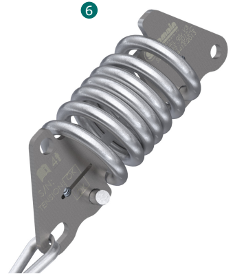
REF : 102173 Amortiguador de energía con anilla, instalado en un extremo de la línea de vida, permite reducir esfuerzos sobre la estructura en caso de caída. • Trazabilidad mediante número de serie único. • Provisto de indicador de tensión y de caída.
