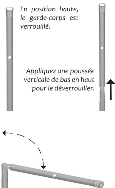
Puis basculez le montant en position basse. Faites l'opération inverse pour mettre le **SECURILISSE®** en position opérationnelle.
