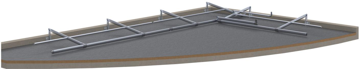
Klappen Sie die Geländerläufe zur Innenseite der Vorrichtung hin um.
